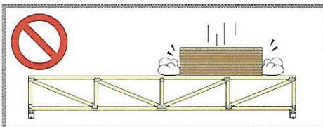
**SI** deje materiales de construcci n arriba del equipo de levantar hasta la instalaci n, si es posible.
