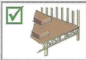
**SI** distribuye cargas sobre el mayor numero de trusses que sea posible. Posicione perpendicular a los trusses los montones de materiales llanas con la dimensi n m s larga como se indica el dibujo.
